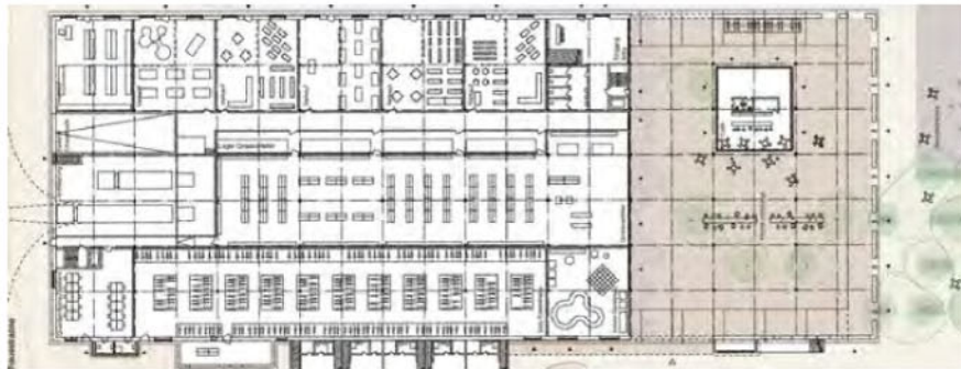
Abb. 37 Grundriss Shedhalle mit Reuss- bühlplatz
